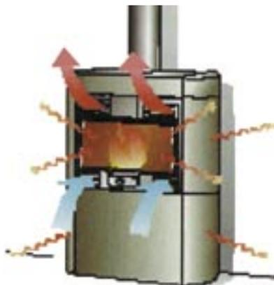
L'aria calda viene diffusa negli ambienti sia gradualmente per moto naturale (convezione naturale), oppure più velocemente (convezione forzata) con l'uso di elettro-ventilatori.
