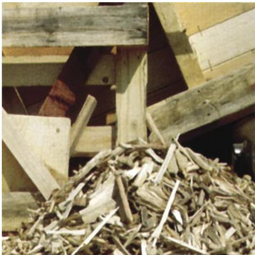
La dimensione dei pezzetti non dovrebbe superare i 4 – 5 cm. Pezzi più lunghi di 7 – 8 cm, anche se presenti in quantità modesta, possono provocare inceppamenti nel sistema di alimentazione della caldaia, e quindi il blocco dell'impianto.
