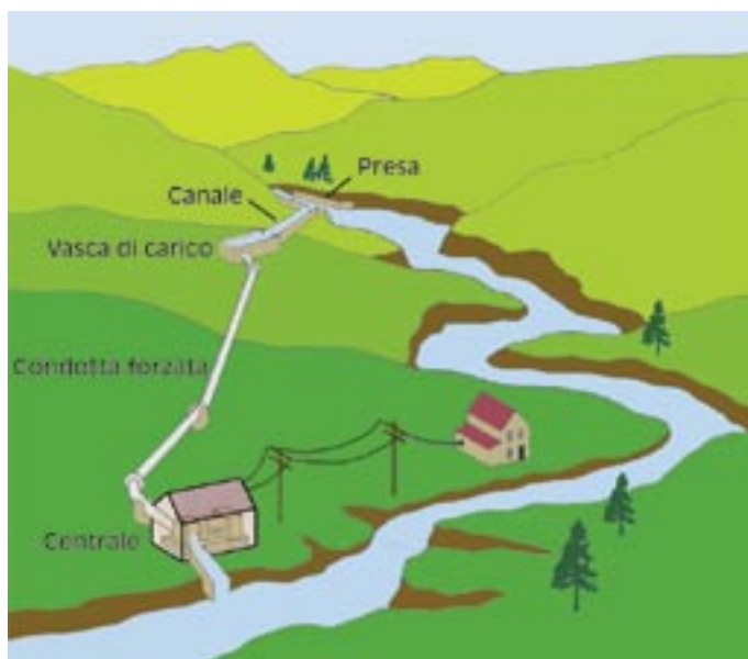
Schema di un impianto idroelettrico
