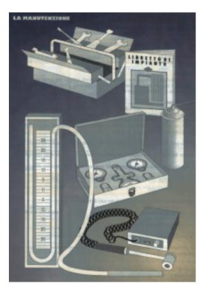
La legge prevede altresì di effettuare ogni due anni la verifica del rendimento di combustione della caldaia. Questa operazione misura i valori delle emissioni in atmosfera per il rispetto dell'ambiente e indica l'efficienza con cui la caldaia brucia il combustibile. La prova di combustione serve anche per verificare l'efficienza della canna fumaria e ad evitare i ritorni dei gas di scarico, che potrebbero essere fonte di pericolosi incidenti.
