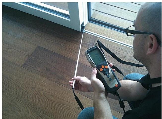
Test di tenuta all'aria in corso d'opera e verifica delle infiltrazioni puntuali con l'ausilio di un anemometro.
